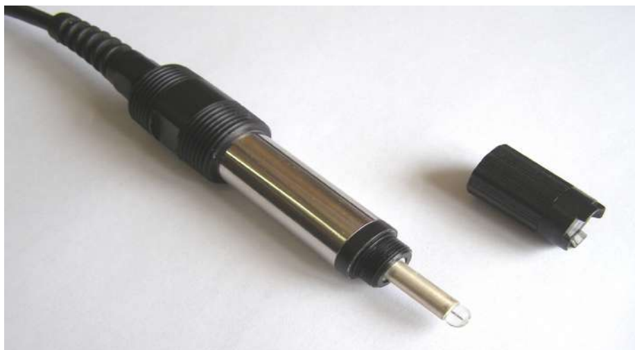
Рисунок 6 - Датчик кислорода со снятым мембранным картриджем
