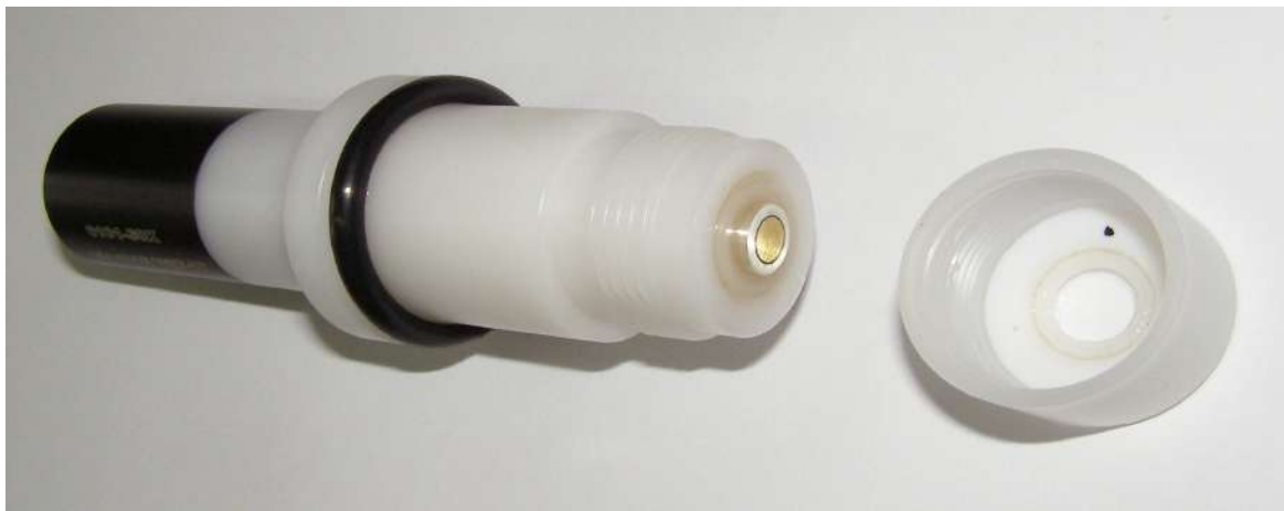
Рисунок 3 - Датчик кислорода со снятым мембранным картриджем
