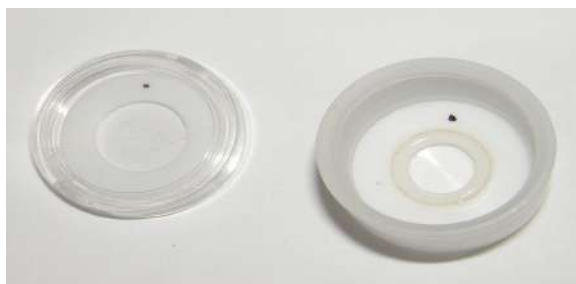
Рисунок 4 - Мембранный картридж в контейнере и колпачок датчика кислорода
