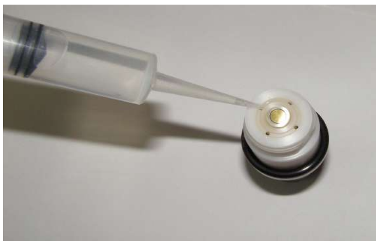
Рисунок 5 - Заливка электролита в датчик
